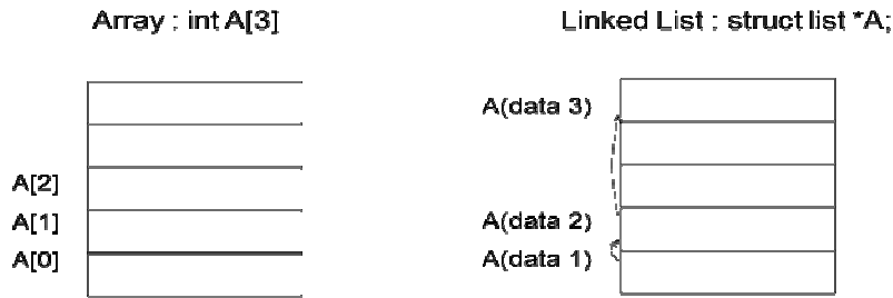
Gambar 5.1 Perbedaan Penempatan di Memory untuk Array dan Linked List
